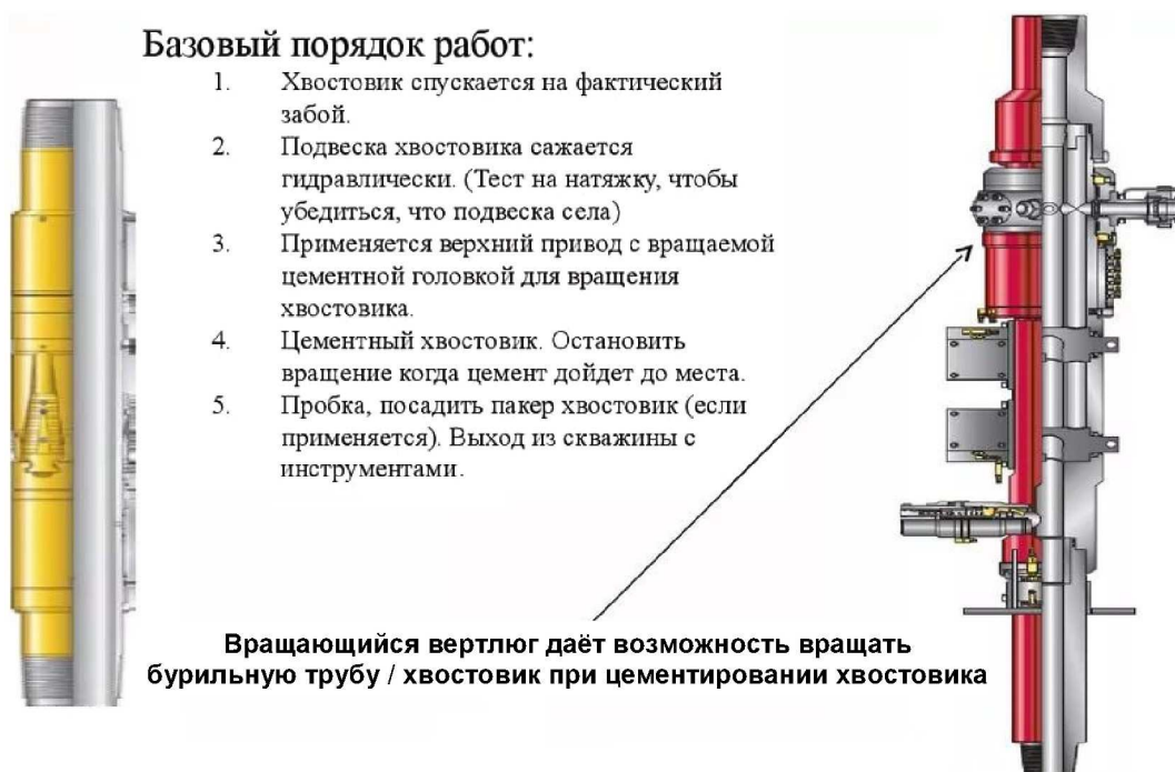
Рисунок 3 – Вращающаяся подвеска хвостовика и цементировочная головка
