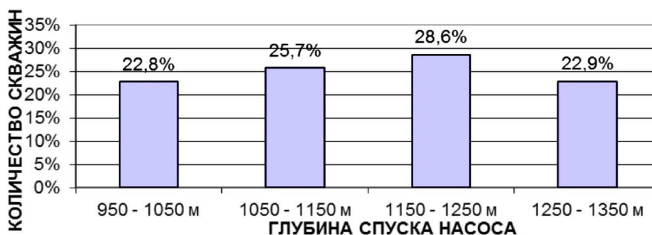
Рисунок 5 – Распределение УШГН по глубине спуска насоса
