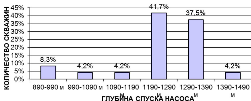
Рисунок 6 – Распределение УЭЦН по глубине спуска насоса
