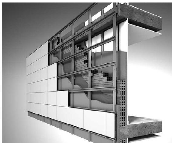
Рисунок 5 – конструкция современной стены
