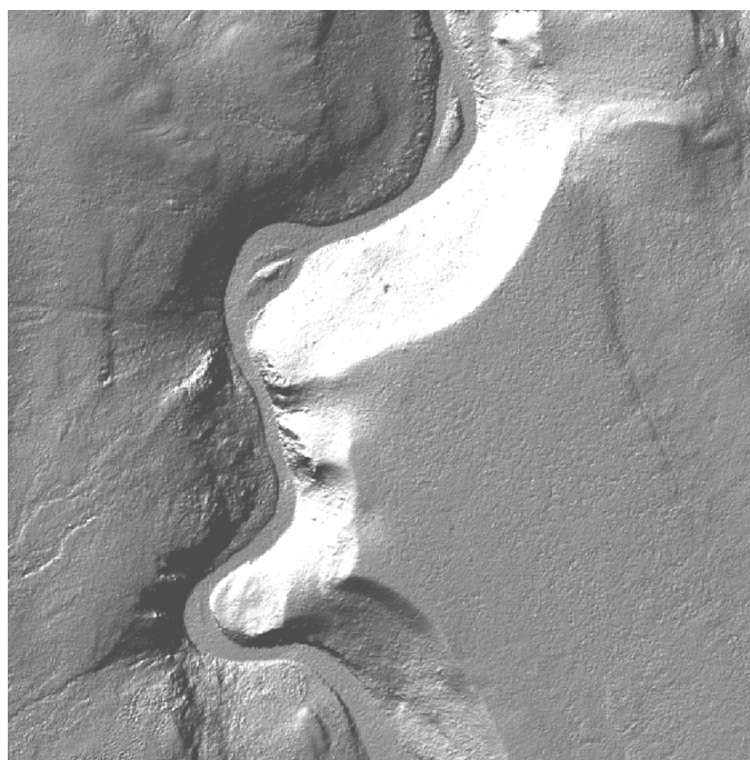
Рис. 3. Растровое изображение в виде светотеневой модели поверхности, созданной на основе точек лазерного отражения
