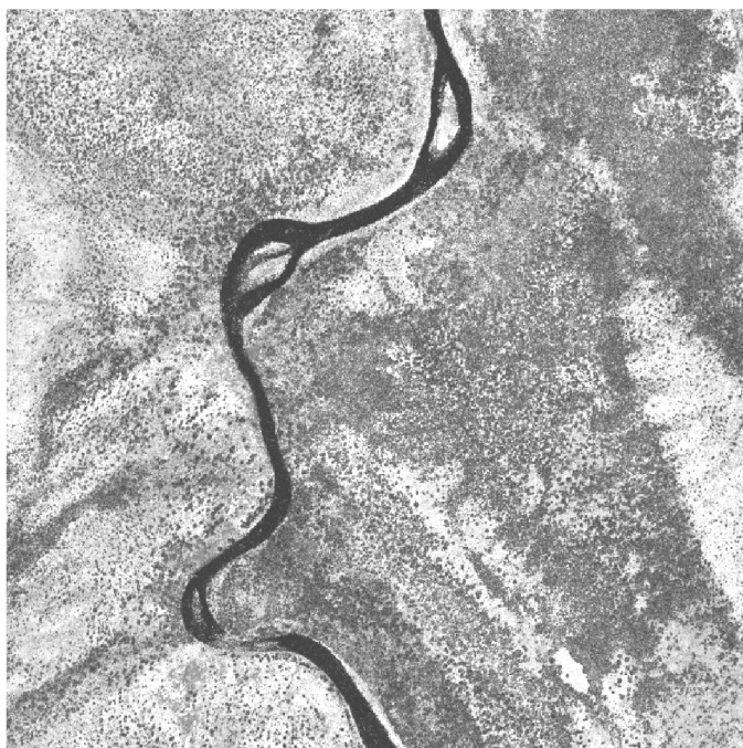
Рис. 1. Растровая геоповерхность, построенная по интенсивности отражения точек лазерного сканирования
