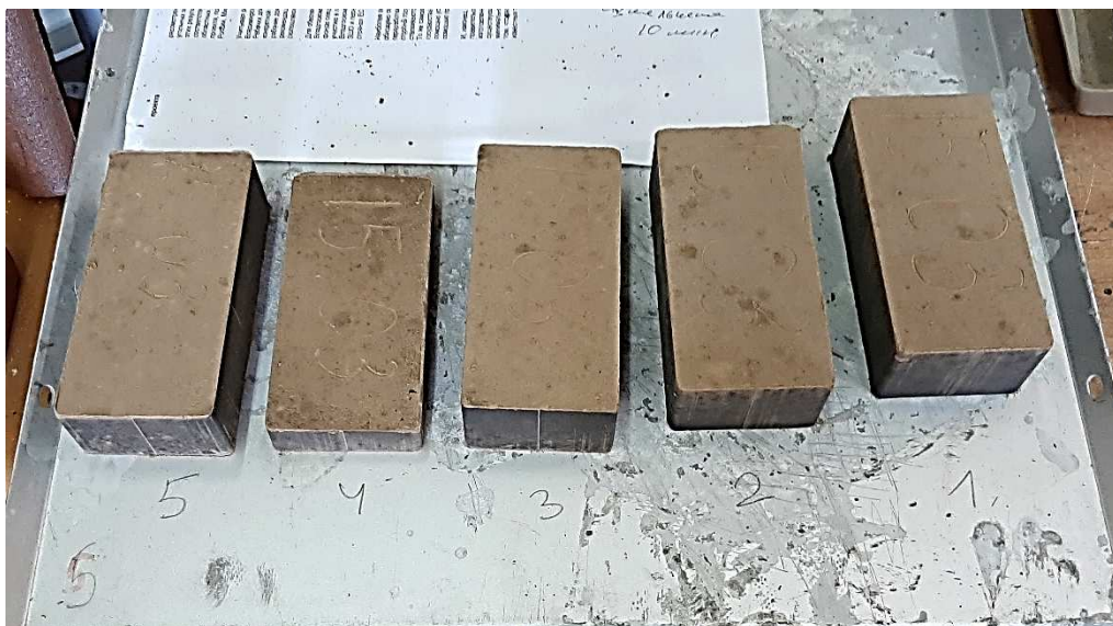
Рисунок 1 – Внешний вид образцов-призм геополимерного бетона
