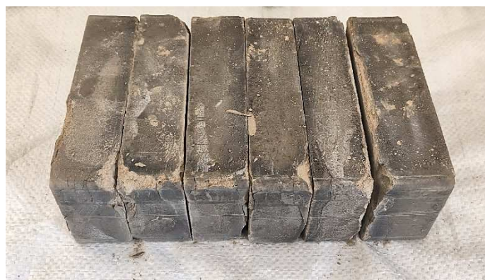
Рисунок 2 – Образцы-призмы из геополимерного бетона, подготовленные для испытания
