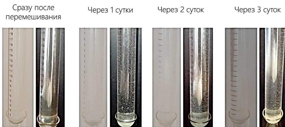
Рисунок 3 – Результаты определения термической устойчивости жидкости глушения (раствор \text{CaCl}_2 , 1,20 \text{ г/см}^3 ).
