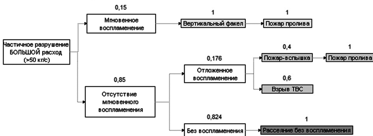
Рисунок 1 – Типовое дерево событий при аварии на магистральном трубопроводе с нефтью под давлением, инициируемой в результате частичного разрушения трубопровода (большой расход истечения, тип разгерметизации «свищ»)
