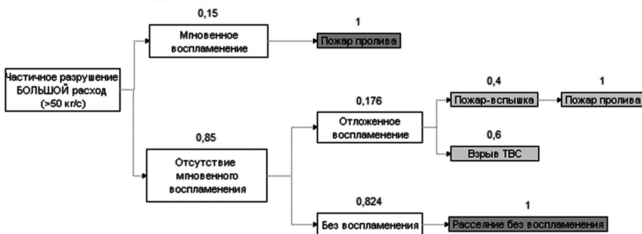
Рисунок 2 – Типовое дерево событий при аварии на магистральном трубопроводе с нефтью под давлением, инициируемой в результате частичного разрушения трубопровода (большой расход истечения, тип разгерметизации «трещина»)
