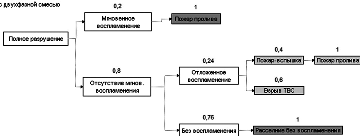
Рисунок 3 – Типовое дерево событий при аварии на магистральном трубопроводе с нефтью под давлением, инициируемой в результате полного разрушения оборудования (тип разгерметизации «гильотинный» разрыв)
