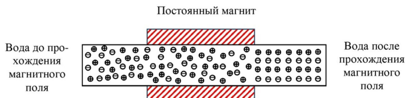
Рисунок – Влияние силы магнитного поля на движение ионов кальция и магния в воде
