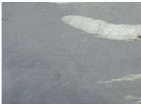
Рисунок 3 – Послойные линзовидные скопления известковистого материала в породах из интервала 2816,0–2815,80 м скважины № 4
