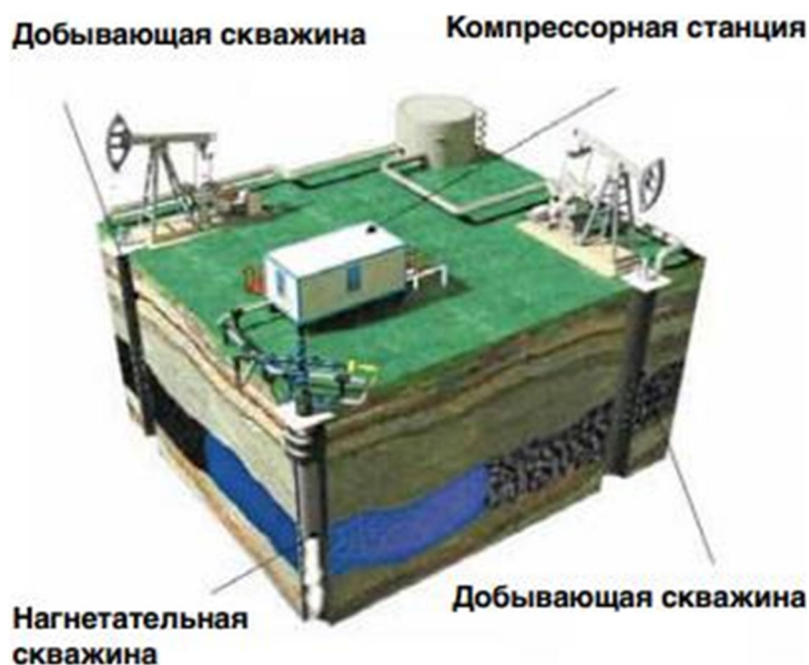
Рисунок 11 – Принципиальная схема реализации термогазового воздействия
