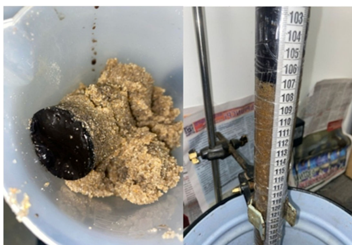
Рисунок 2 – Результат пропитки горной породы исследуемым раствором
