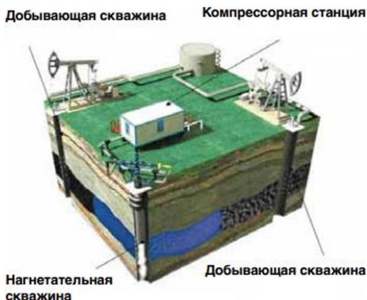
Рисунок 11 – Принципиальная схема реализации термогазового воздействия
