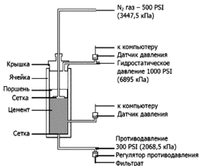
Рисунок 2 – Миграция газа с обычным цементом и с наночастицами [4]
