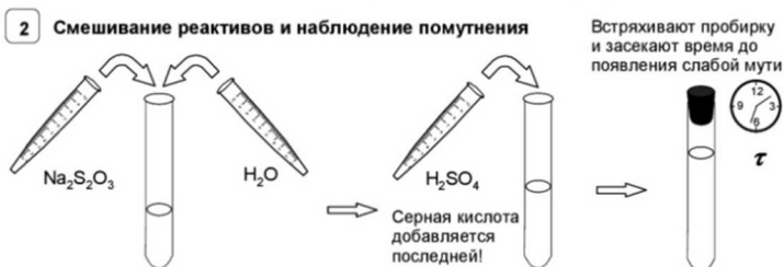
Рисунок 1 – Опорная схема по изучению влияния концентрации на скорость химической реакции \text{Na}_2\text{S}_2\text{O}_3 и \text{H}_2\text{SO}_4
