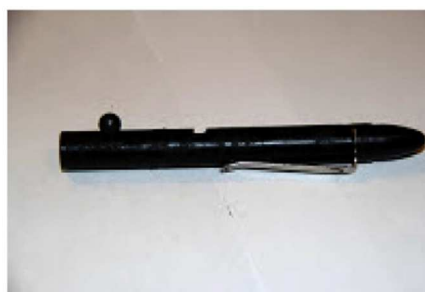
Рисунок 9 – Приспособление для отстрела 15-ти мм сигнальных патронов из авиационного НАЗа
