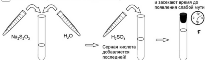
Рисунок 1 – Опорная схема по изучению влияния концентрации на скорость химической реакции \text{Na}_2\text{S}_2\text{O}_3 и \text{H}_2\text{SO}_4
