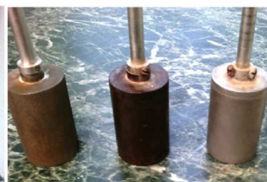
Рисунок 3 – Внутренние цилиндры прибора СНС-2 с различными поверхностями (слева-направо: стальной гофрированный, стальной гладкий, алюминиевый гладкий)
