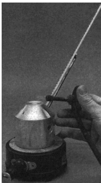
Рисунок 2 – Тестирование горючей жидкости на вспышку в блоке для определения температуры плавления [11]
