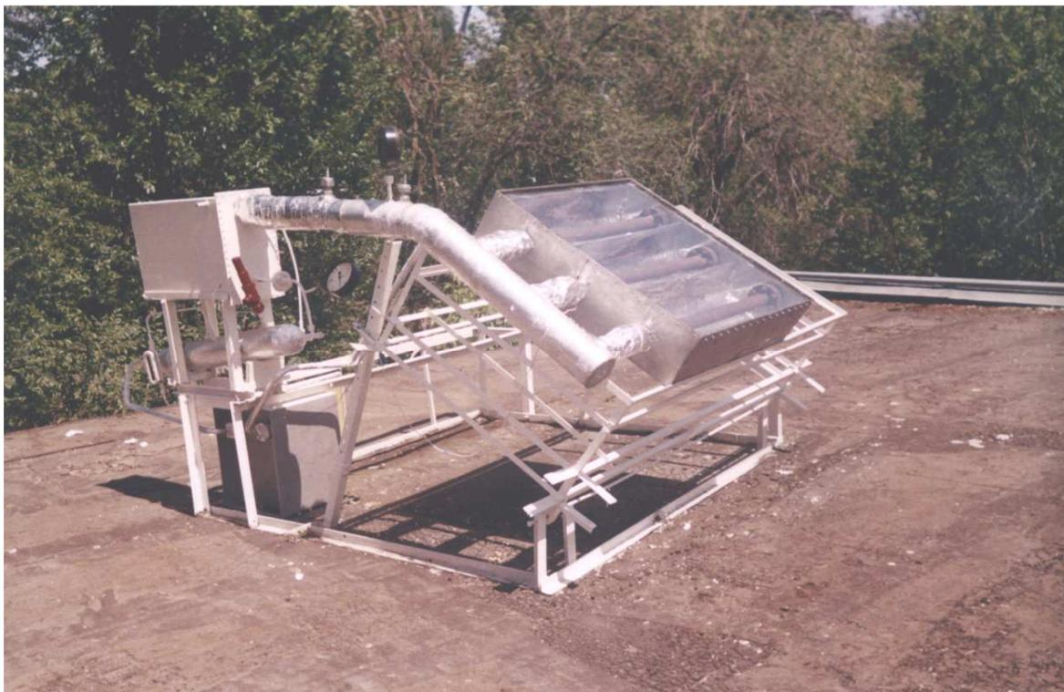
**Рисунок 2** – Гелиоэнергетический холодильник автономного действия, работающий от энергии солнечной радиации
