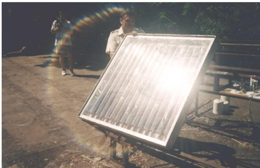
**Рисунок 1** – Солнечный коллектор для водонагревательных установок
