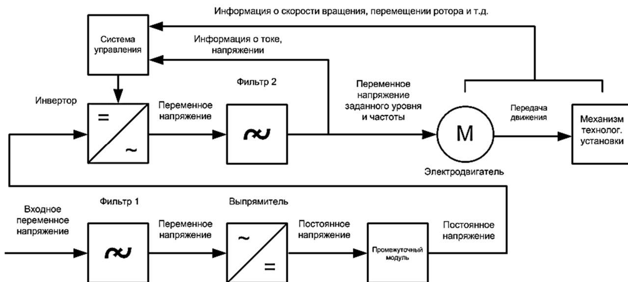
Рисунок 1 – Обобщенная блок-схема ПЧ, работающего на трехфазный электродвигатель
