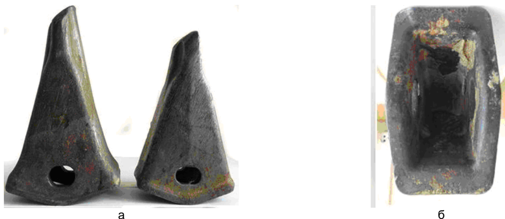
Рисунок 1 – Изношенные коронки рыхлителя: а) общий вид; б) вид сверху
