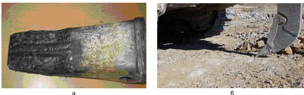
Рисунок 2 – Наплавленная коронка рыхлителя: а) общий вид; б) испытания на излом при разных углах атаки
