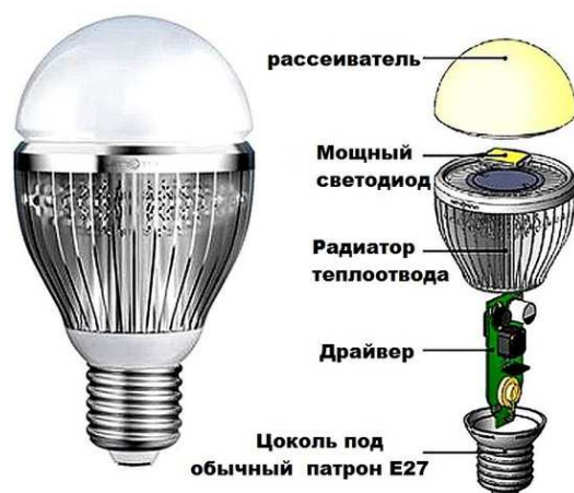
Рисунок 1 –Устройства светодиодной лампы
