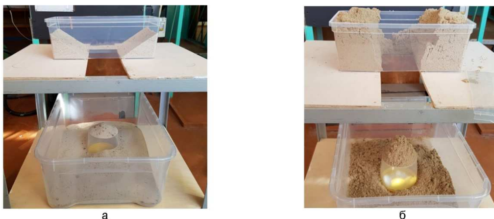
Рисунок 2 – Общий вид экспериментальной установки по определению угла естественного откоса в покое и угла естественного обрушения: а – сухой песок, б – увлажненный песок
