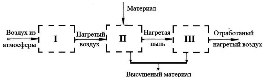
Рисунок 3 – Схема технологического процесса: I – нагревание воздуха, II – сушка, III – фильтрация
