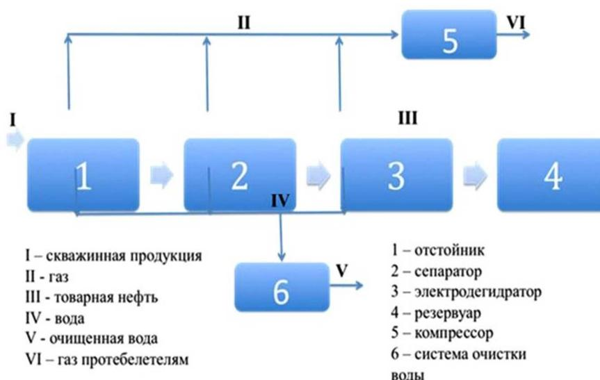
**Рисунок 6** – Блок-схема системы подготовки нефти
