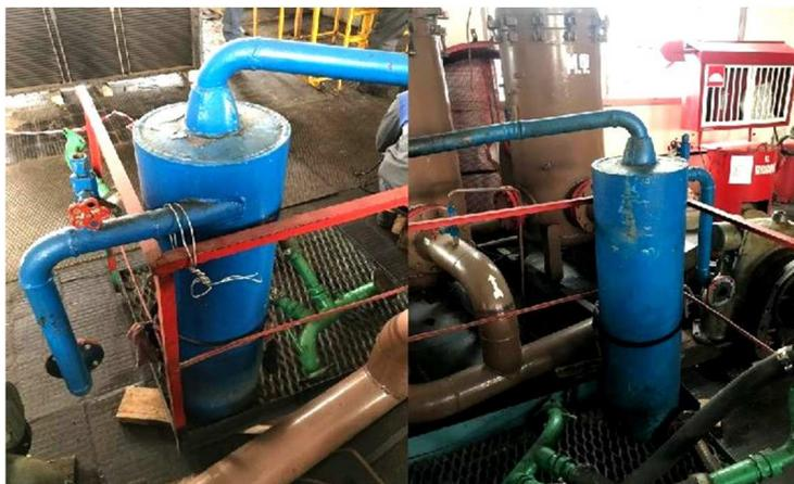
**Рисунок 1** – Центробежный сепаратор для очистки входного воздуха, снятый в ремонтный период с агрегата
