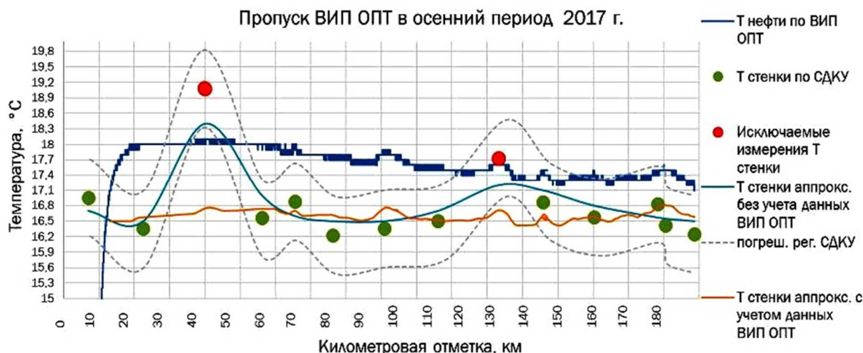
Рисунок 1 – Выбор формы аппроксимирующей функции температуры стенки по длине МН
