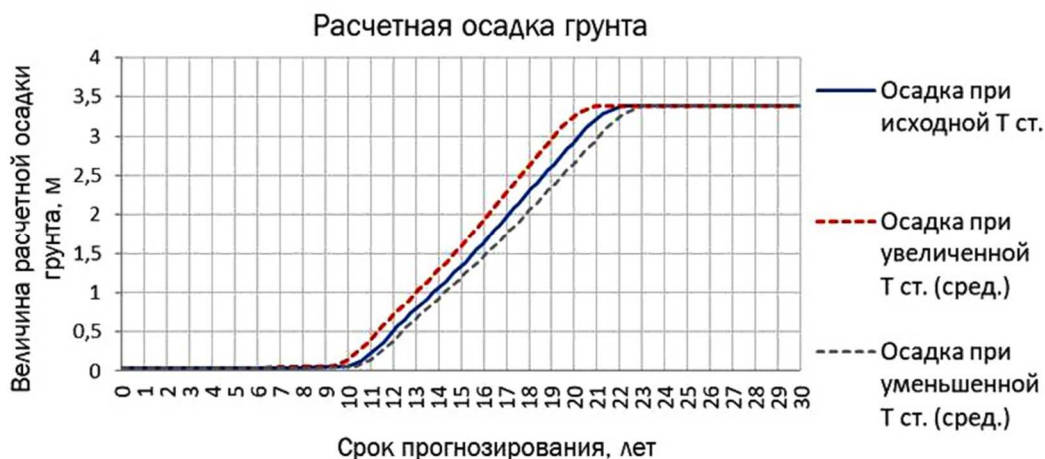
Рисунок 3 – График изменения расчетной осадки грунта по месяцам при изменении температуры стенки МН на заданную величину
