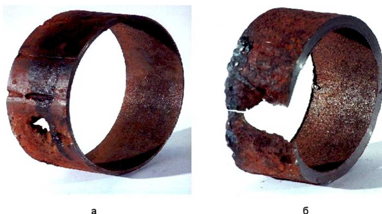
Рисунок 1 – Образцы труб, вырезанные с места порыва нефтепровода, эксплуатировавшегося без ингибиторной защиты (а) и высоконапорного водовода (б)
