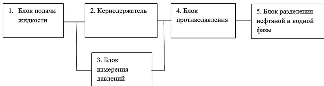
Рисунок 1 – Схема оборудования, входящая в фильтрационную установку
