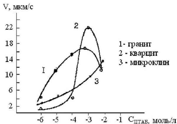
Рисунок 6 – Зависимость скорости бурения алмазной коронкой твердых пород от концентрации водного раствора ЦТАБ [24–26]
