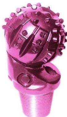
**Рисунок 2** – Общий вид одношарошечного долота 1 – 190,5 СЗ – АУ
