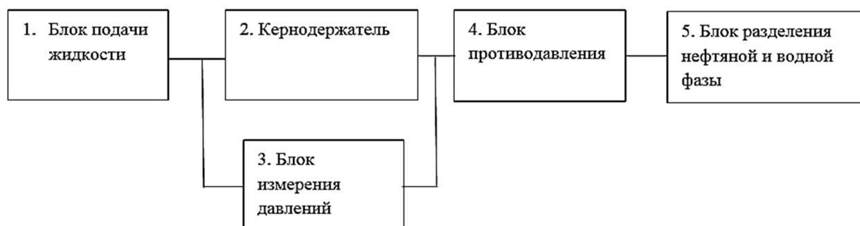
Рисунок 1 – Схема оборудования, входящая в фильтрационную установку
