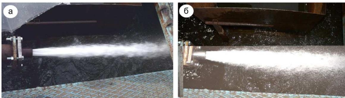
**Рисунок 2** – Форма струи одноствольного сопла (а) и многоствольного сопла (б)
