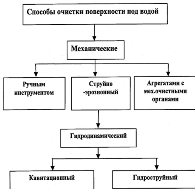
Рисунок 2 – Основные способы очистки поверхностей под водой
