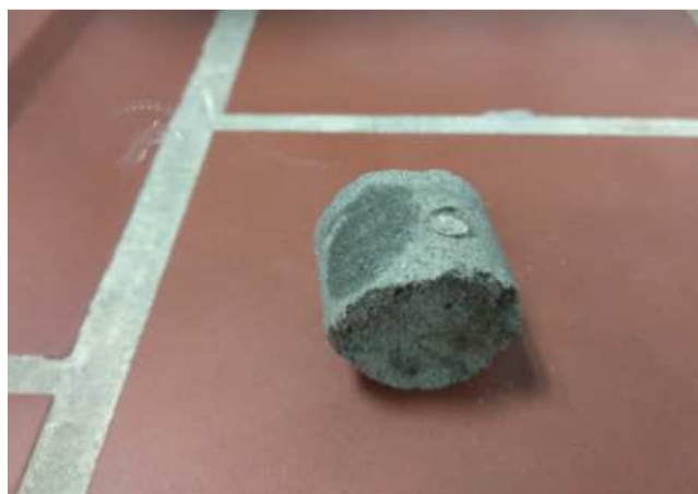
Рисунок 2 – Проверка гидрофобности образца после обработки реагентом: слева – след от впитавшегося керосина, справа – капля воды
