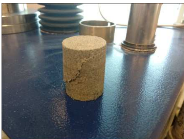
Рисунок 1 – Фотография песчаника, консолидированного при помощи смол, после испытаний на слом
