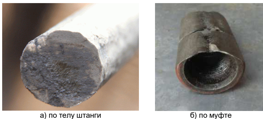
Рисунок 2 – Элементы обрыва штанговой колонны
