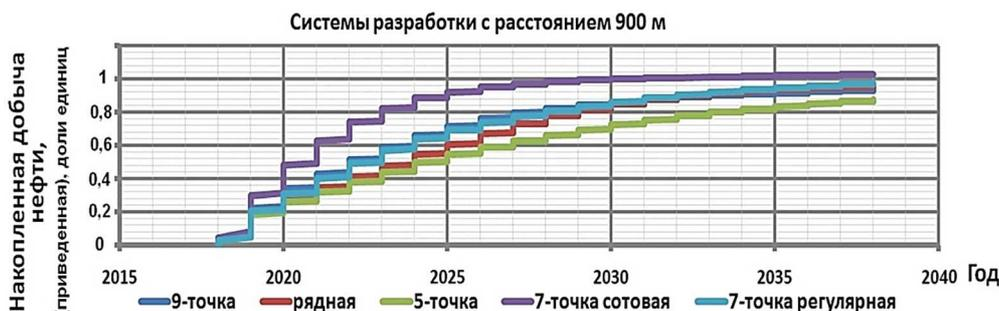
Рисунок 4 – Расчёты по темпам выработки для различных систем разработки
