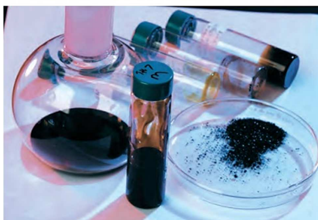
Рисунок 2 – Разделение сырой нефти методом фракционирования SARA [1, с. 29]
