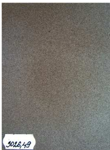
Рисунок 2 – Пласт Ач (БС 4 ), глубина отбора 3026,49 м: массивный мелкозернистый песчаник с глинисто-карбонатным цементом
