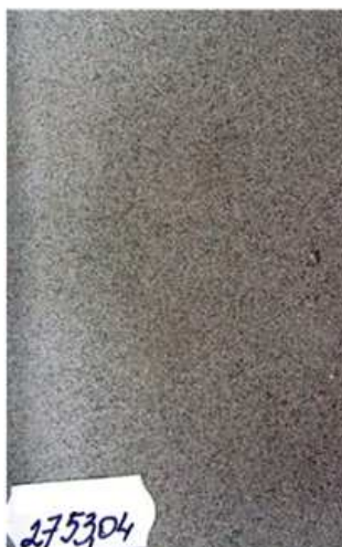
Рисунок 11 – Пласт БВ 8 , глубина 2753,04 м: массивный мелко-среднезернистый песчаник
