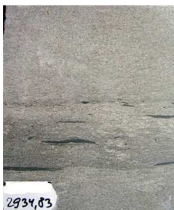
Рисунок 4 – Пласт Ач (БВ 4 ), глубина отбора 2934,83 м: массивный тонкозернистый песчаник с деформациями и аллохемами аргиллита
