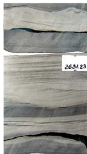
Рисунок 8 – Пласт Ас 1 (БВ 4 ), глубина отбора 2631,23 м: неравномерное переслаивание песчаника тонкозернистого и аргиллита с текстурами ряби течения, с четкими литологическими границами, с мелкими аллохемами аргиллита, по напластованию развит УРД
