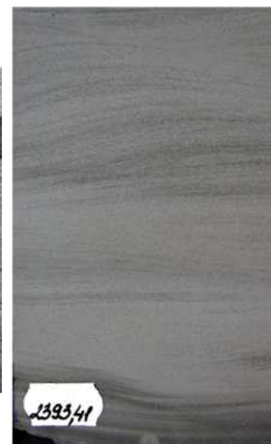
Рисунок 14 – Пласт БВ 10 , глубина 2393,41 м: тонко-мелкозернистый песчаник с рябью течения
