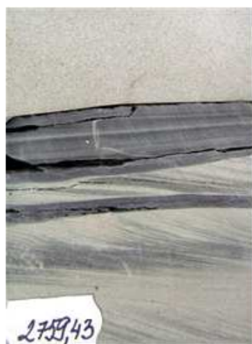
Рисунок 15 – Пласт БВ 8 , глубина отбора 2759,43 м: тонко-мелкозернистый песчаник с рябью течения с прослоем алевритистого градационного аргиллита
