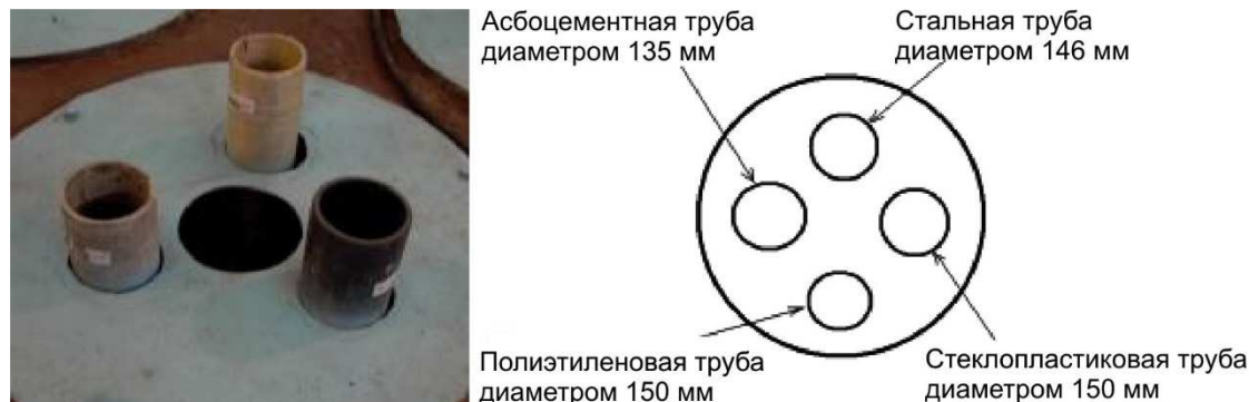
Рисунок 1 – Схема и фото комплекта трубных волноводов для аппаратуры АК
