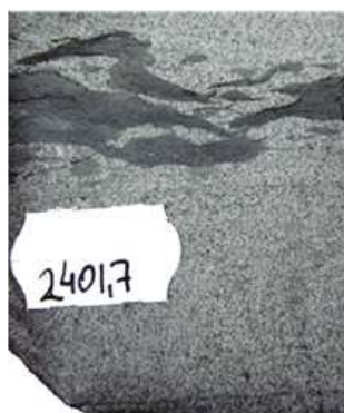
Рисунок 13 – Пласт БВ 10 , глубина 2401,7 м: мелко-среднезернистый песчаник с крупными неокатанными аллохемами аргиллитов
