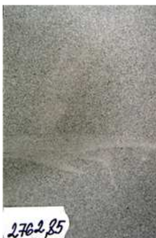
Рисунок 12 – Пласт БВ 8 , глубина 2762,85 м: мелко-средне-зернистый песчаник с пламенной текстурой
