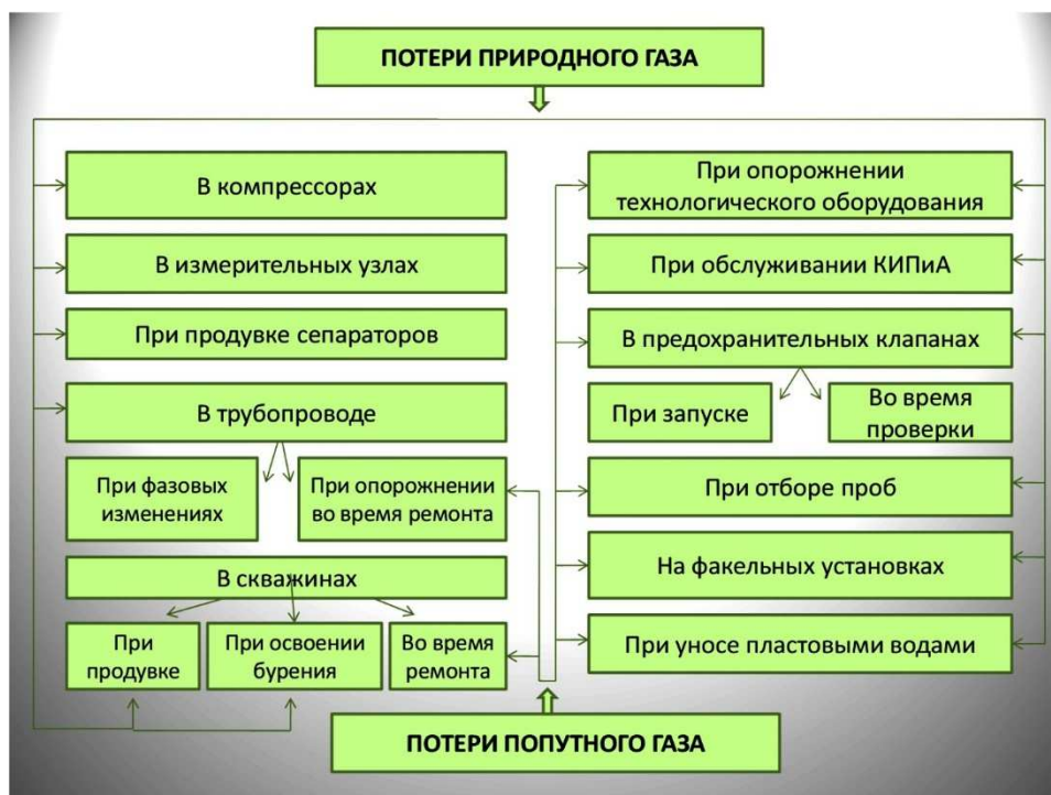
Рисунок 1 – Классификация источников технологических потерь газа
