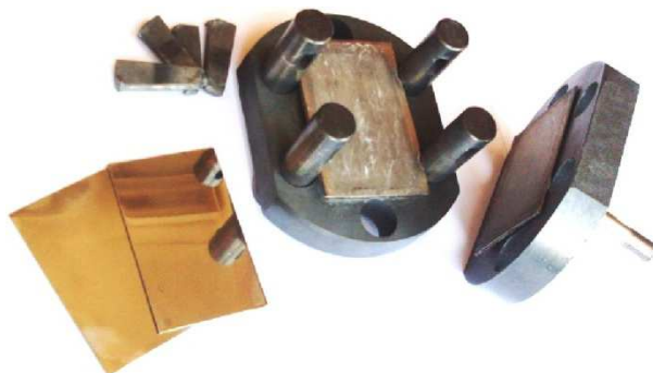
Рисунок 1 – Общий вид инструментальной оснастки для сварки давлением титановых листовых заготовок посредством давления газа через гибкую мембрану
