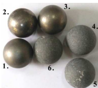
Рисунок 3 – Истирание стальных шариков (12 мм) в процессе химических воздействий
