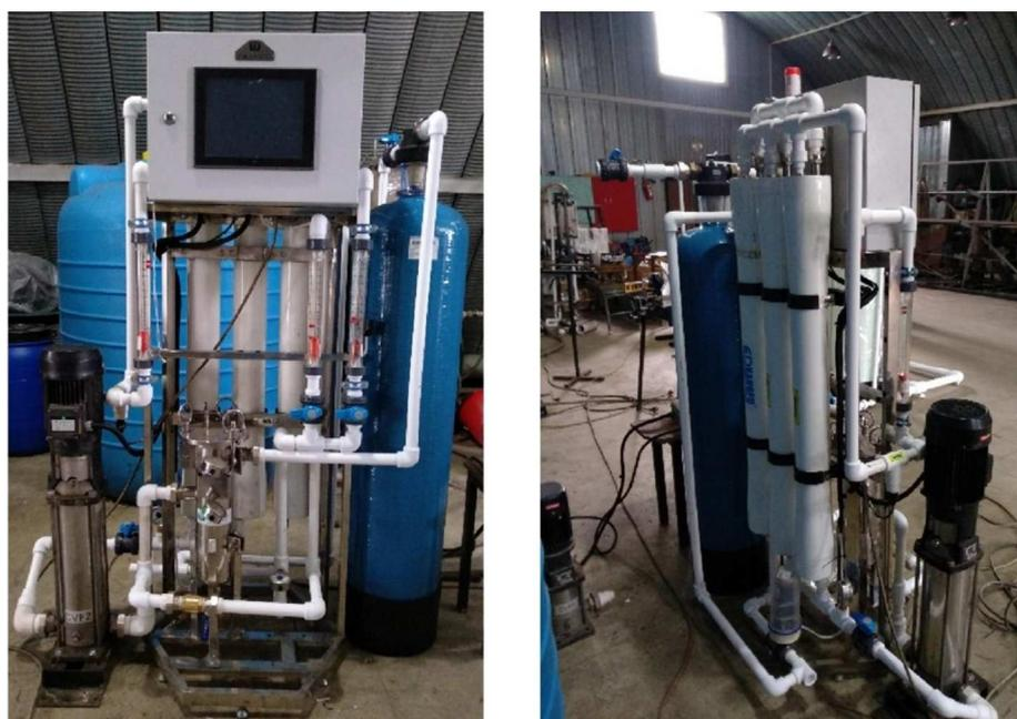
**Рисунок 1** – Общий вид пилотной обратноосмотической установки производительностью 700 л/ч
