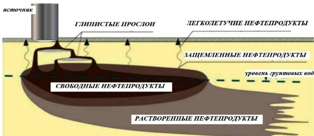
Рисунок 1 – Схема распределения форм нефтяных углеводородов при их фильтрации в грунте
