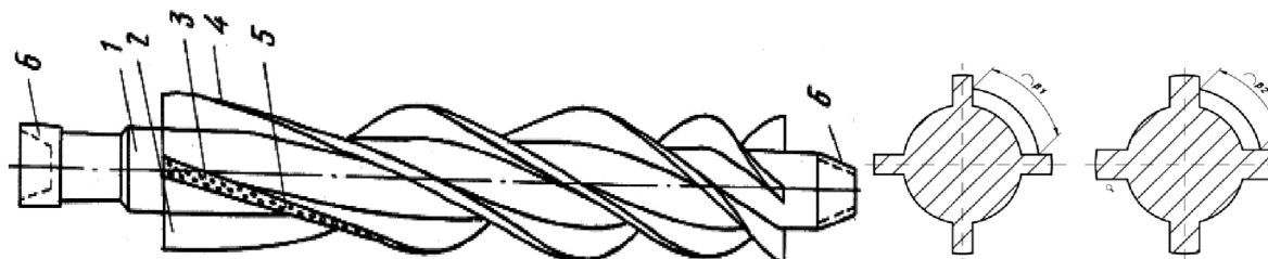
Рисунок 7 – Калибратор-интенсификатор и схема уменьшения межлопастного пространства: 1 – корпус; 2, 4 – спиральные лопасти; 3, 5 – твердосплавные материалы; 6 – резцы
