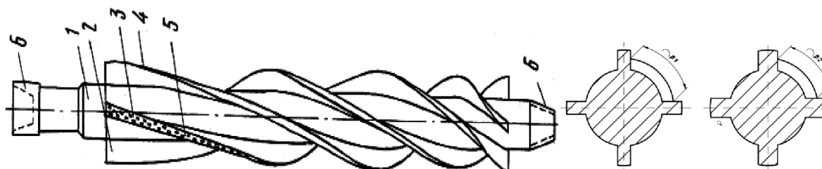
Рисунок 7 – Калибратор-интенсификатор и схема уменьшения межлопастного пространства: 1 – корпус; 2, 4 – спиральные лопасти; 3, 5 – твердосплавные материалы; 6 – резьбы
