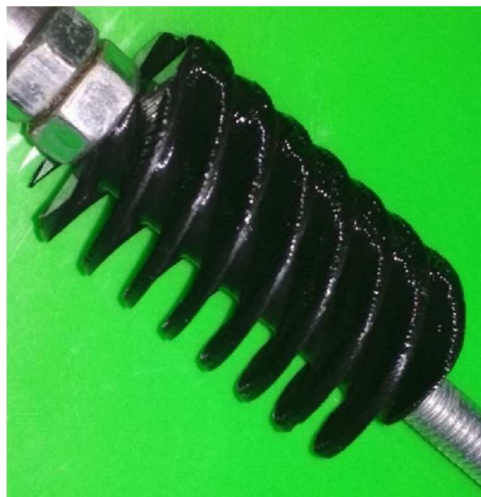
Рисунок 5 – Ротор микромодели лабиринтно-винтового насоса
