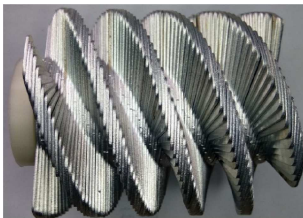
Рисунок 6 – Прототип ротора лабиринтно-винтового насоса, изготовленный методом аддитивных технологий «SheetLamination»
