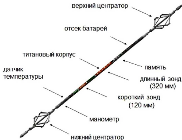
Рисунок 1 – Конструкция магнитно-импульсного дефектоскопа
