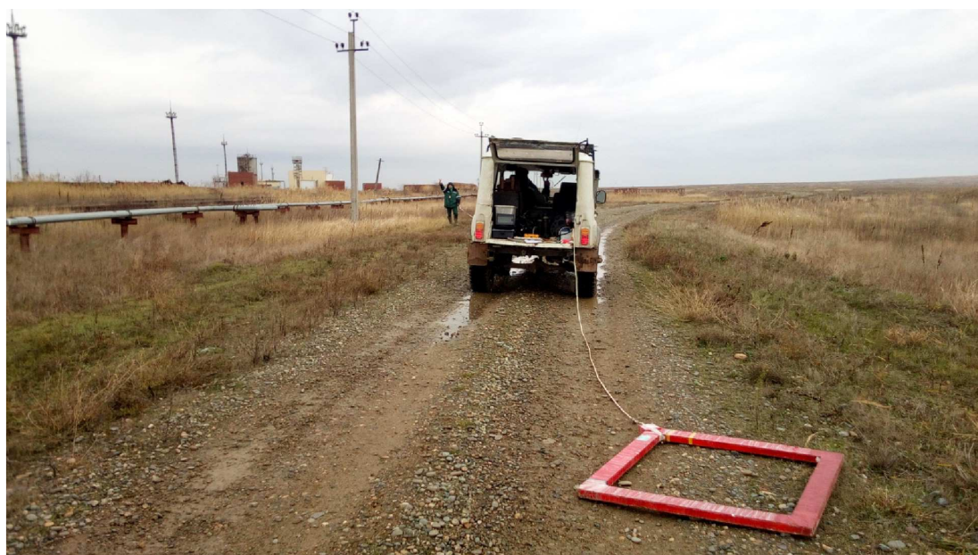
Рисунок 1 – Пример отработки по профилю (установка петля-петля)
