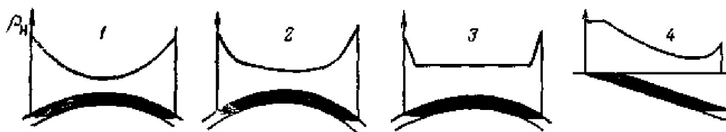
Рисунок 1 – Принципиальная схема изменения плотности нефти по объёму залежей (по А.А. Карцеву)
