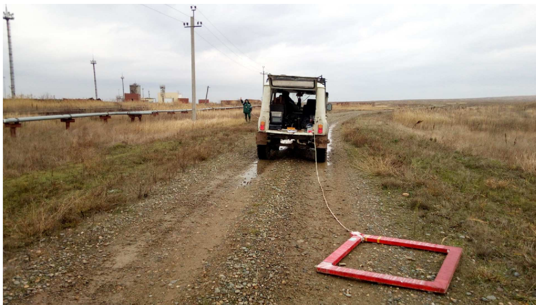
Рисунок 1 – Пример отработки по профилю (установка петля-петля)
