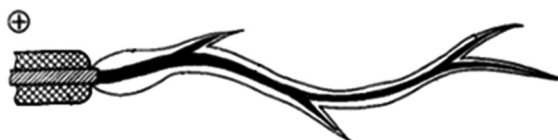
Рисунок 1 – Растущий стример на электроде
