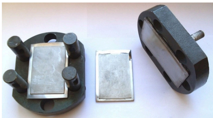
Рисунок 1 – Общий вид инструментальной оснастки для сварки давлением листовых заготовок титанового сплава ВТ6 посредством давления газа через гибкую мембрану
