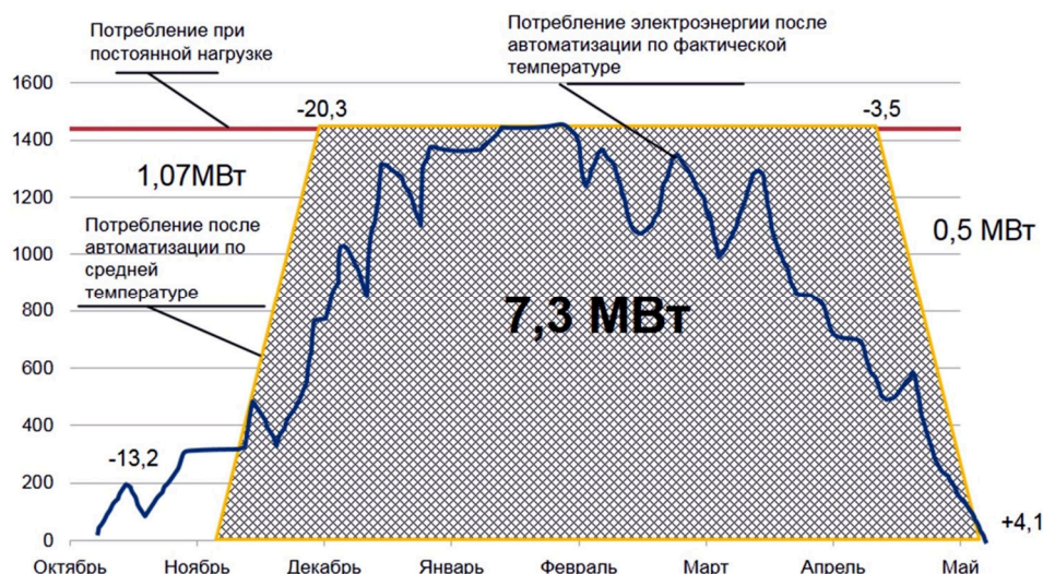
Рисунок 3 – Потребление электроэнергии при регулировке работы электрообогрева
