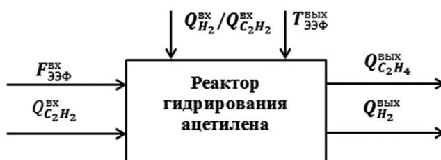
**Рисунок 1** – Структурная схема реактора гидрирования ацетилена как объекта управления:
